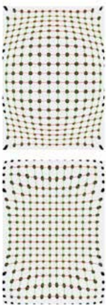
a) 15%TV 负波畸变 图 1. 10 安装网格示例 b) 15%TV 正波畸变
